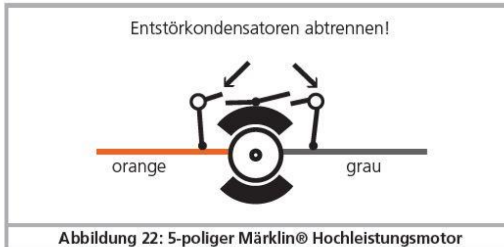
Illustration 22 : moteur Märklin à 5 pôles à haute performance. (Enlevez les condensateurs!)
